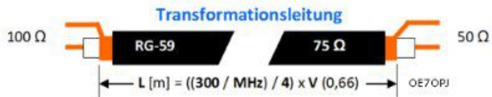
Beispiel Transformationsleitung für das 6m Band nach GW7AAV Steve
