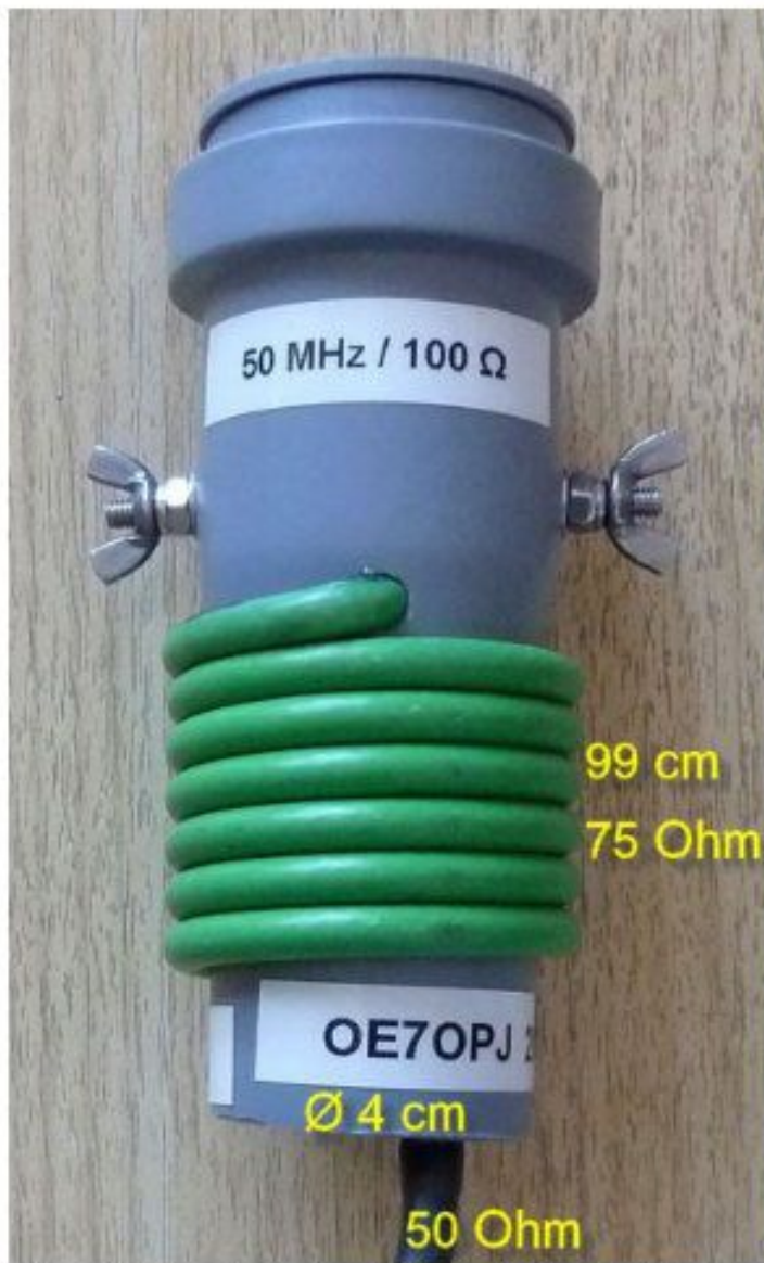
Beispiel Transformationsleitung für das 6m Band nach GW7AAV Steve
